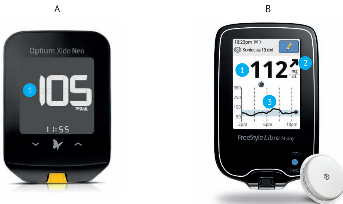
Ryc. 1. Pomiar glikemii za pomocą glukometru i flash glucose monitoring (FreeStyle Libre). A. Glukometr – konieczność nakłucia opuszki palca. B. FreeStyle Libre – „skanowanie” sensora dedykowanym czytnikiem lub urządzeniem mobilnym.
